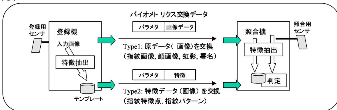
バイオメトリックスモデルにおける本人確認は、上図のように、センサからのデータ入力、特徴抽出などの前処理の後、事前に登録しておいた生体情報（テンプレートデータ）との照合処理により、類似度を算出する。
